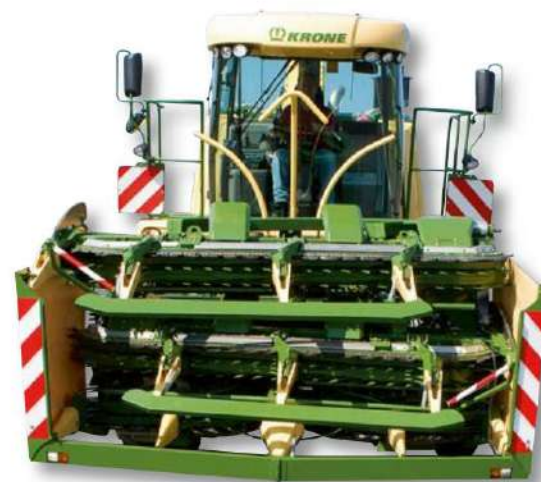
Posição compacta de transporte: O cabeçalho EasyCollect triplo
